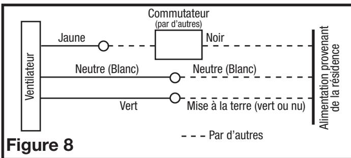
**REMARQUE :** Les fils du réceptacle du ventilateur pourraient nécessiter d'être tirés à l'extérieur du compartiment pour le raccordement. Tirer uniquement les quatre fils lâches à l'extérieur du compartiment. Des fils additionnels y sont présents.
