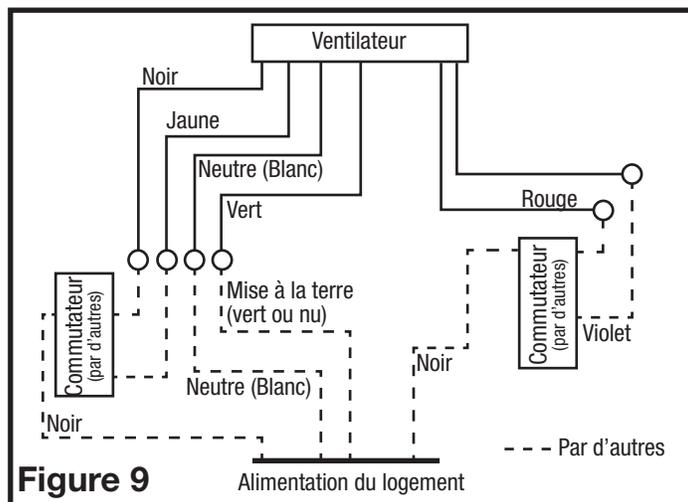
4. Regrouper soigneusement les fils à l'intérieur du compartiment pour le raccordement et replacer le couvercle du compartiment en le fixant avec la vis qui fut enlevée précédemment.
