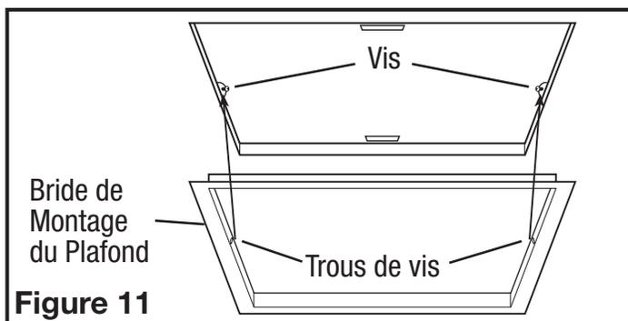
**REMARQUE :** Si le boîtier est monté très loin ou pas assez loin dans le plafond pour pouvoir fixer solidement la bride, desserrez le canal de montage et ajustez le boîtier vers le haut ou vers le bas sur les rails. Une fois en place, serrez les écrous de montage du canal.
